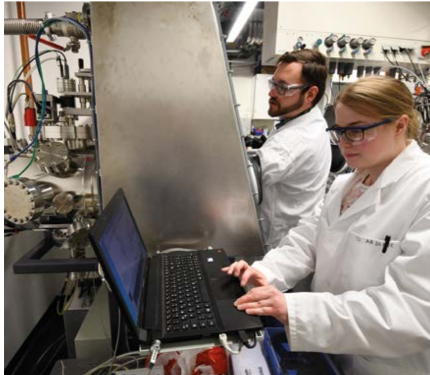
Abb. 85: Herstellung dünner Schichten mit einer Magnetron-Sputteranlage.
