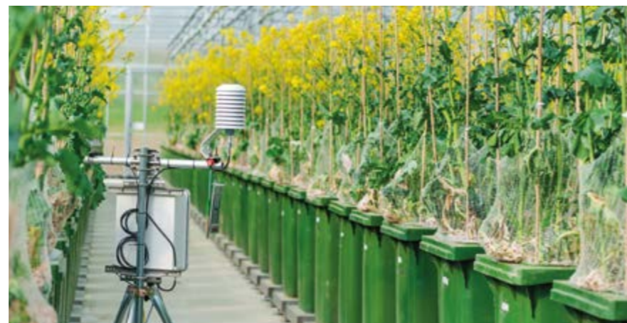
Abb. 146: DroughtSpotter-XXL-Anlage im Gewächshaus: Eine weltweit einzigartige Einrichtung, mit der die Reaktionen von über 1.000 Pflanzen auf Dürrestress unter kontrollierten Bedingungen über das gesamte Jahr mit höchster Genauigkeit in fünfminütigen Abständen automatisch erfasst werden können.
